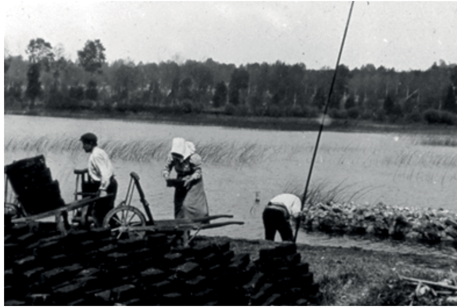
Figure 4 Extraction familiale de la tourbe aux environs d'Amiens au début du XX ème siècle, à l'aide du grand louchet. On aperçoit des herbiers à Schoenoplectus lacustris au sein du plan d'eau récent. Photo : Coll. privée
